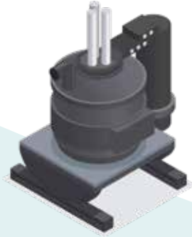
EAF: Electric Arc Furnace / Lò điện hồ quang
